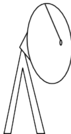
FIGURE 5.4 – Récepteur radar. Le principe de fonctionnement (envoi d'une onde et écoute de l'écho sur la cible) n'impose pas l'utilisation d'une antenne parabolique.
